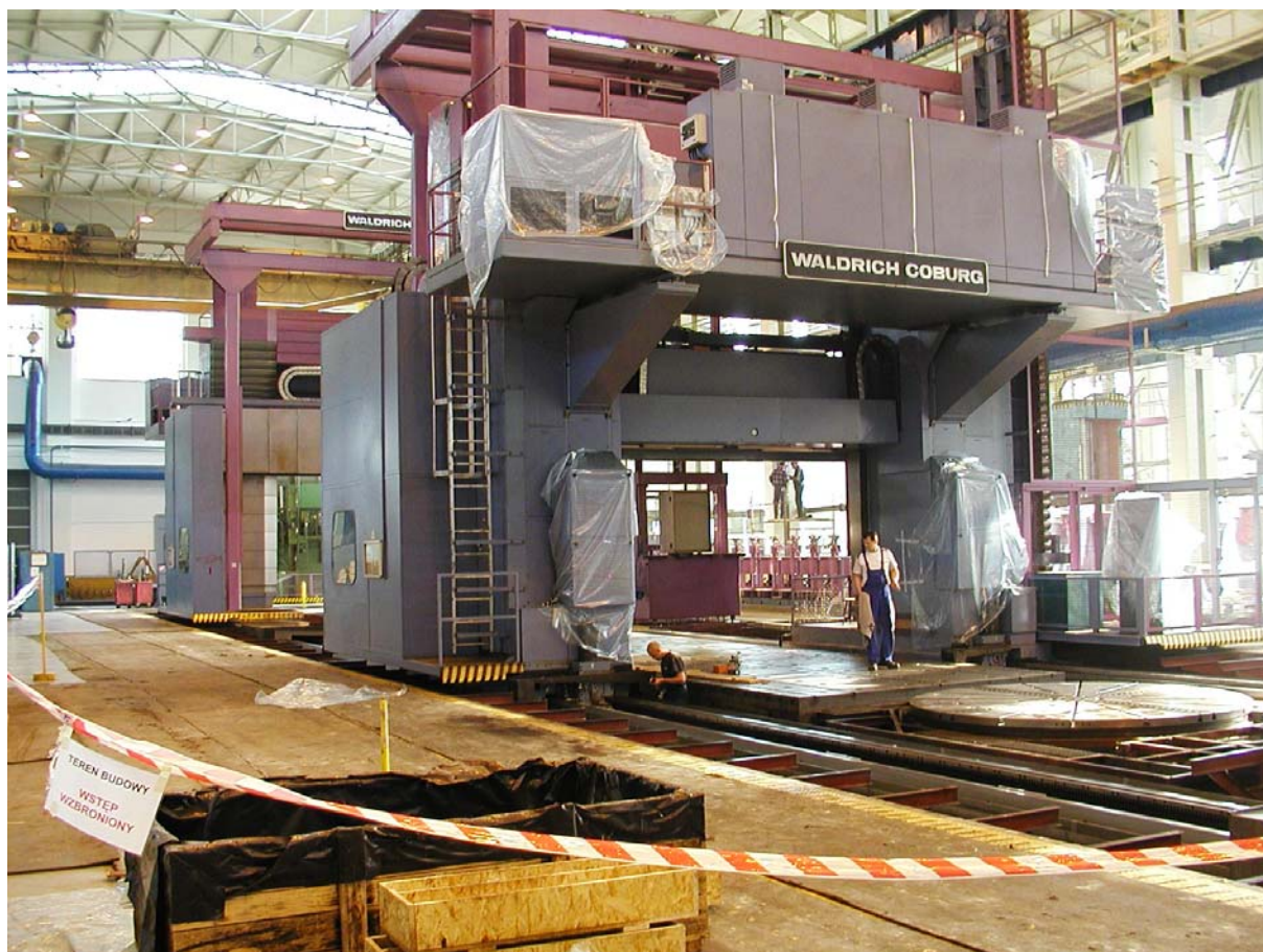
Obr. 1 : Dvouportálové obráběcí centrum Wadrich-Coburg
