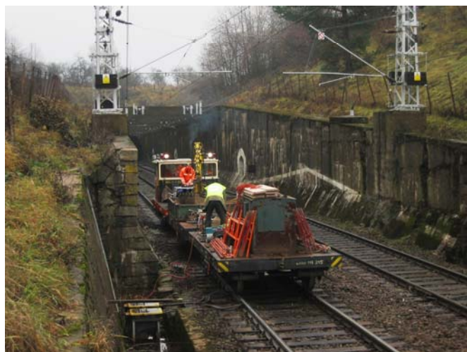
Pracovní plošina pro provádění inspekce a diagnostiky
